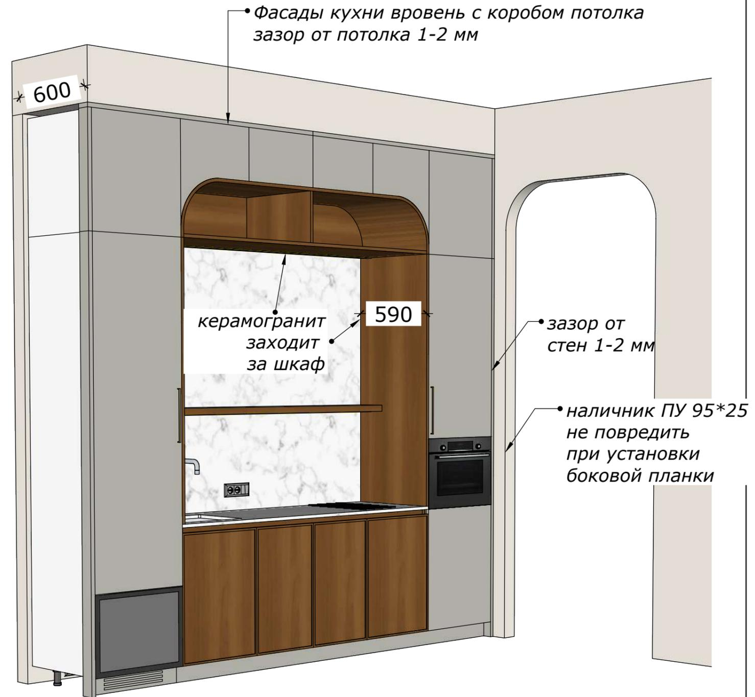
Фартук кухни из керамогранита (2600 \* 1600 мм) толщина с клеем 10 мм заходит за шкафы (установлен до монтажа кухни)
